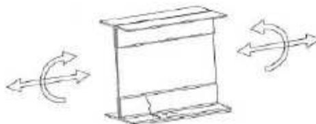
spojení pásnice a krčních úhelníků
